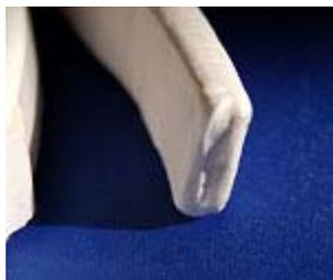
**Структура:** НП 3000 ЛС - набивка формованная из экспандированного фторопласта прямоугольного сечения.
